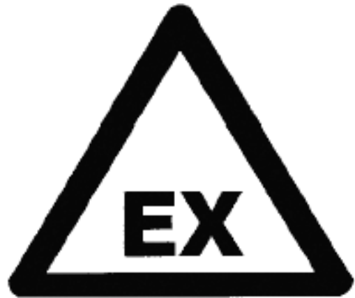
Zona con riesgos de atmósferas explosivas
