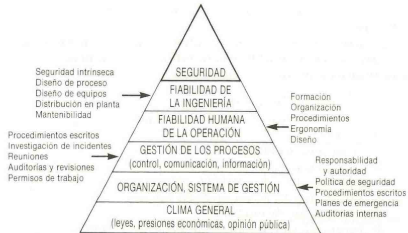
Figura 8.1. Pirámide de los distintos niveles de causas de accidentes en relación con el sistema de gestión de seguridad. (Basado en la referencia 29.)
