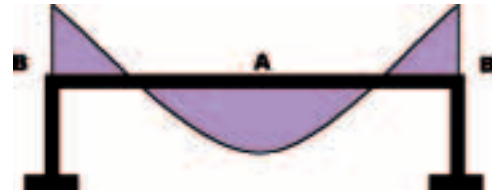
Gráfica de los momentos flectores esperados en el dintel.
