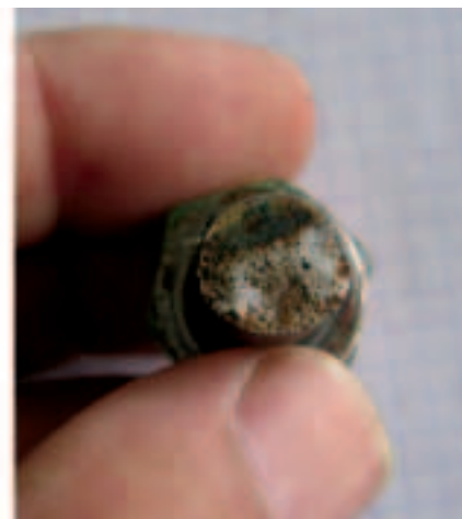
Detalle de una de las uniones atornilladas de la estructura en la que han desaparecido los hilos de la rosca de los tornillos y detalle de uno de los tornillos rotos.
