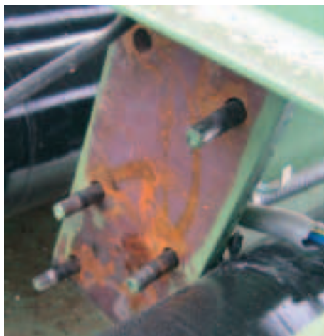
Detalle de una de las uniones atornilladas de la estructura en la que han desaparecido los hilos de la rosca de los tornillos y detalle de uno de los tornillos rotos.
