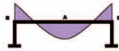
Gráfica de los momentos flectores esperados en el dintel.
