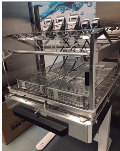
FIGURA 5. Rack Da Vinci Xi, con capacidad máxima para 14 instrumentos y 2 ópticas
