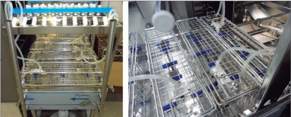
FIGURA 6. Accesorio MIC en una lavadora MAT LD500, preparado con tubos de irrigación finalizados con adaptadores luer lisos cónicos, que permiten su conexión con los puertos de limpieza del instrumental Versius
