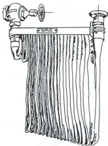
Figura 35. Boca de incendio equipada (soporte de plegadera).
