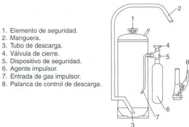
Figura 15. Extintor no permanentemente presurizado de botellín exterior con válvula en el extremo de la manguera.
